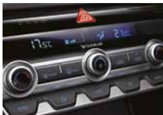
Sistem automat de climatizare
